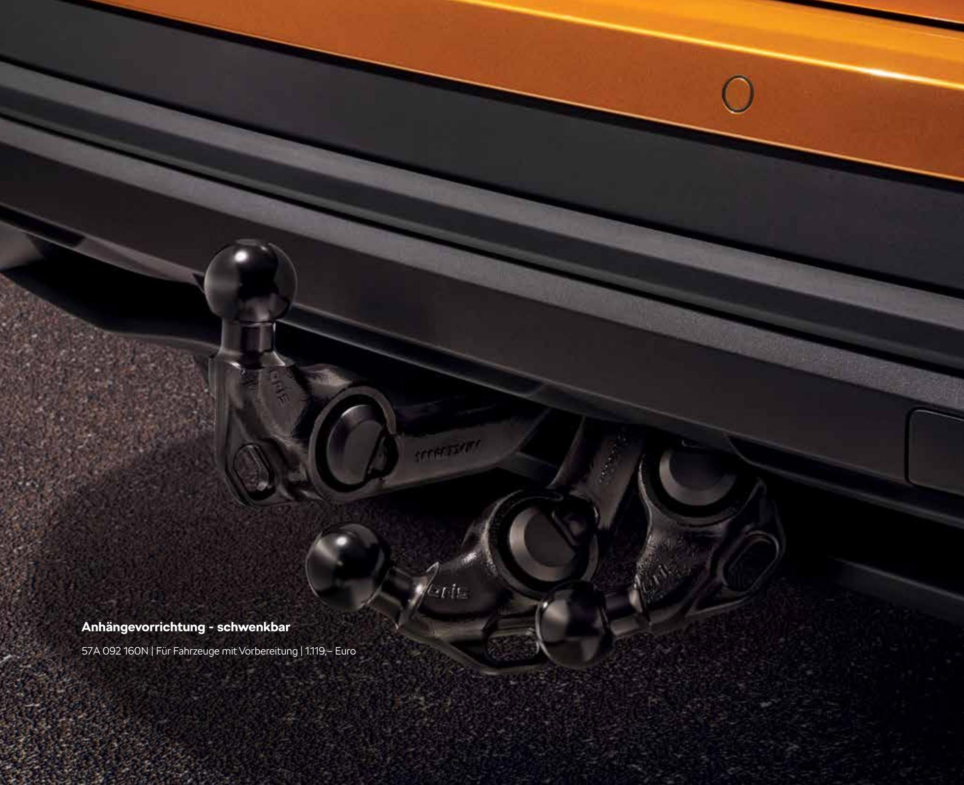
**Anhängevorrichtung - schwenkbar**
